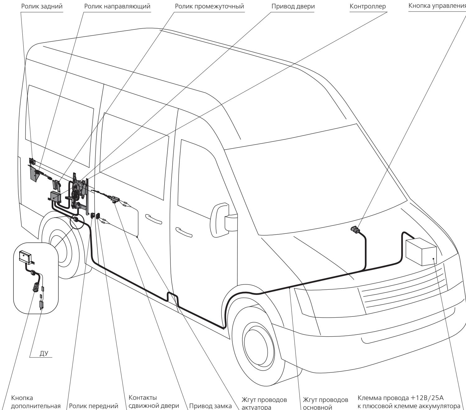
Данная модель привода предназначена для открытия и закрытия правой сдвижной двери микроавтобуса «Hyundai Grand Starex».
