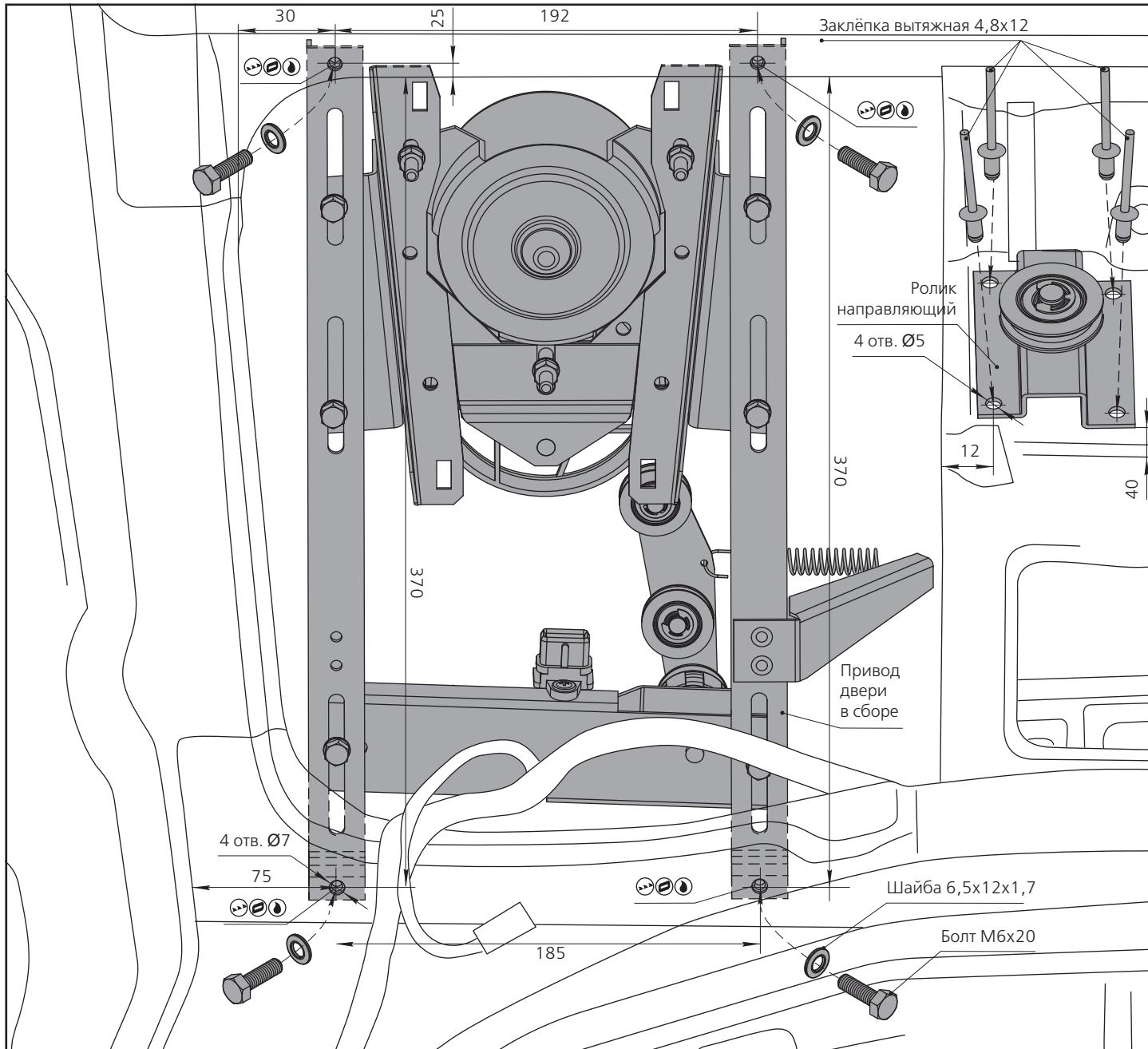
**3.5.12** Приложите плотно к каркасу кузова привод двери в сборе и ролик направляющий, как показано на рисунке. Сделайте метки маркером в местах отверстий.
