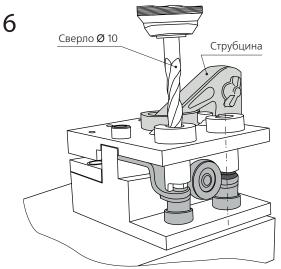
Высверлите с помощью сверла  $\mathcal O$  10 из комплекта нижние части (шляпки) на двух штатных направляющих роликах.
