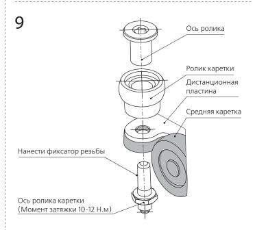
Установите и закрепите ролики на каретку из комплекта.
