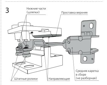
Закрепите проставку верхнюю двумя винтами М6 к плите верхней и с помощью направляющих на проставке вставьте в кондуктор среднюю каретку в сборе (не разборную).
