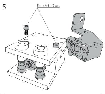
Закрепите среднюю каретку в кондукторе с помощью двух винтов М8.
